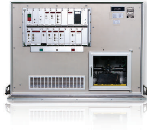
Friction, wear tester / 윤활유 마찰, 마모 측정장비 < / 潤滑油摩擦、摩耗測定裝備 / 潤滑油摩擦磨損測試設備
