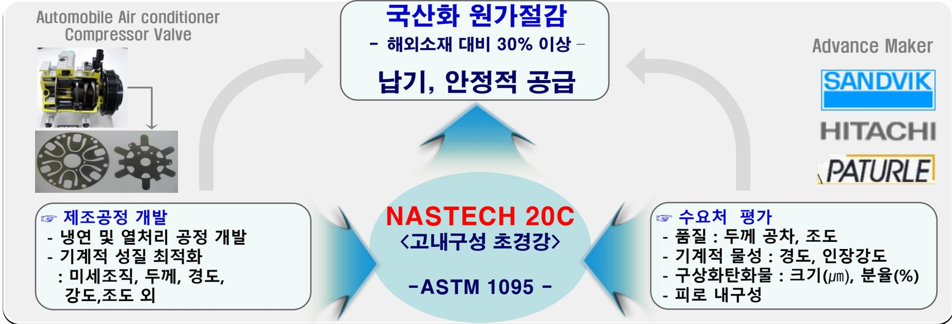
※ Martensite + 미세구상 탄화물 ( $2 \mu\text{m}$ 이하, 5~10%) : Valve의 내구성 및 내마모성 향상
